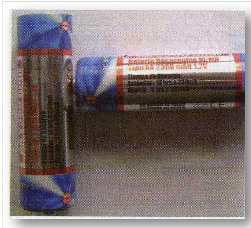
Figura 4. Pila tipo AA 1.2V 2.300 mAh
