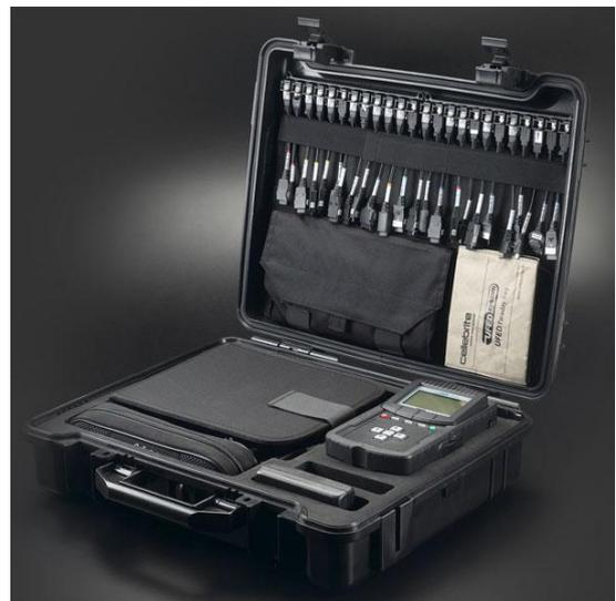
Ilustración 2:UFED: Dispositivo universal de extracción forense para teléfonos móviles, smartphones y PDA.
